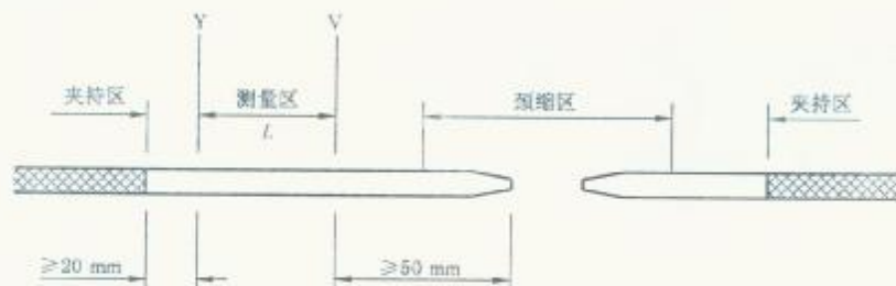
图 A.1 断裂后的测量
